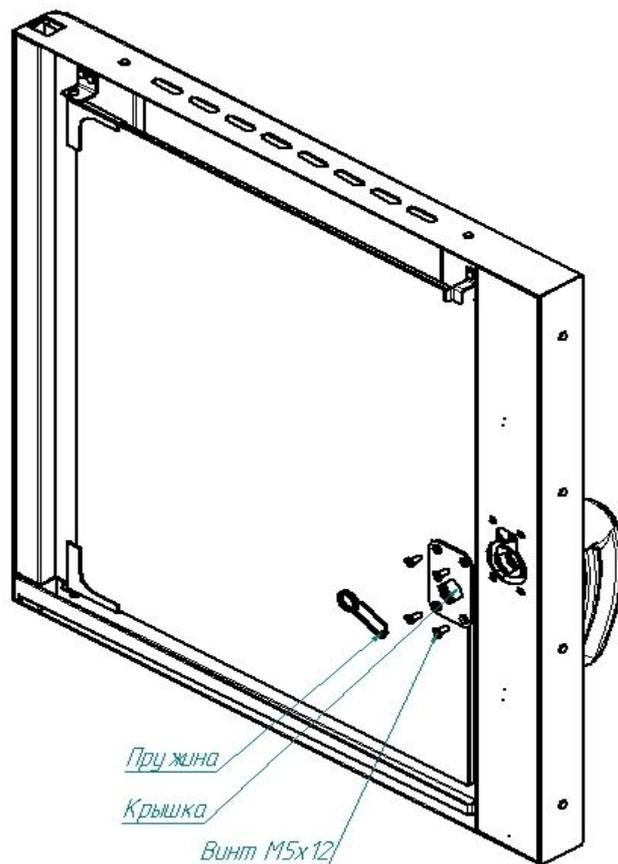
Рис. 10. Ремонт замкового устройства
